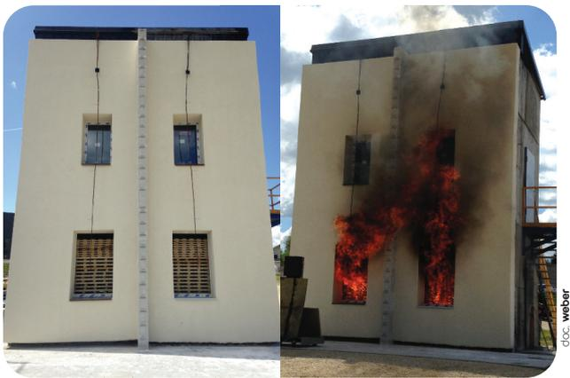
Le test LEPIR 2 réalisé le 25 avril 2016 s'avérant concluant, **weber** peut prétendre à une bande coupe-feu tous les 2 étages (au lieu d'une bande à tous les étages), et jusqu'à 30 cm de PSE pour son système **webertherm XM** : une solution d'ITE sous enduit hydraulique qui va au-delà de la réglementation !
